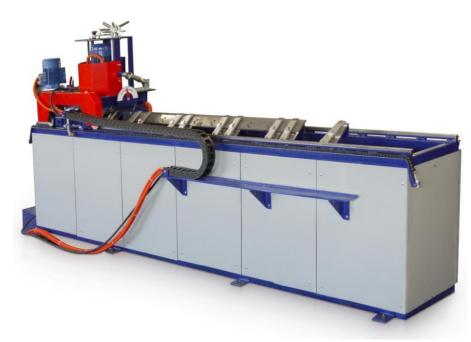
Станок имеет два исполнения различающихся по точности: «St» - стандартная точность, «Ultra» - повышенная точность, а так же три степени автоматизации: «Р» - ручной привод движения каретки и инструмента, «А» - автоматический привод каретки, ручной привод движения инструмента и «А+» - автоматический привод каретки и автоматический, программируемый привод движения инструмента.
